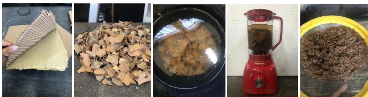
(a) (b) (c) (d) (e) Figura 1: (a) Separação de camadas; (b) Corte; (c) Saturação; (d) Trituração; (e) Peneiramento da polpa de papelão. Fonte: As autoras (2024).
