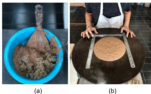
Figura 3: (a) Incorporação de lã de papelão na argamassa; (b) Medição na mesa de consistência. Fonte: As autoras (2024).
