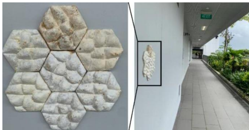
Figura 4: Placa hexagonal rugosa utilizada na simulação do estudo.
