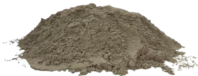
Figura 2: Cinza de jurema-preta passante na peneira de abertura de 75\ \mu\text{m} .
