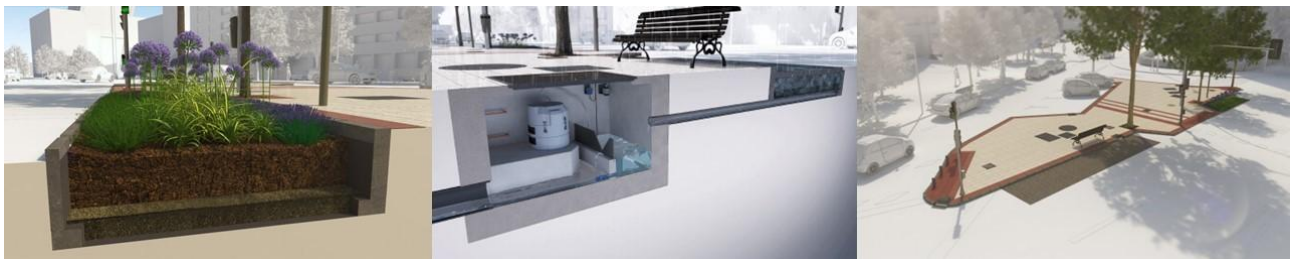
Figura 4: Sistema para monitoramento da qualidade das águas infiltradas. Fonte: Distrito Castellana Norte S.A., (2025a). Organizado pelos autores.
