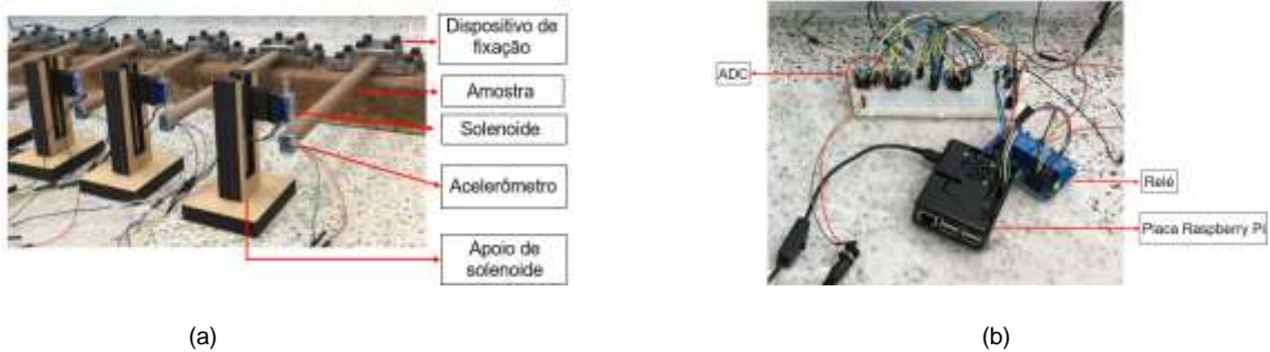
Figura 1: Sistema proposto de 3 canais: (a) configuração física; (b) hardware.
