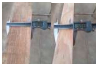
Figura 2 – Demonstração da coleta de dados da seção das peças estruturais de pinus spp. , realizada pelo paquímetro no Laboratório de Maquetes da Universidade Estadual de Londrina (UEL).
