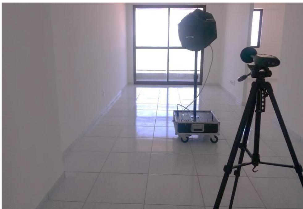
**Figura 1- Medidor de nível de pressão sonora e fonte de ruído -**
