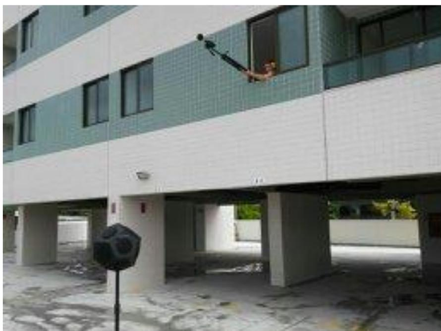
**Figura 2 – Coleta do ruído de emissão no ensaio da vedação externo no 1º pavimento -**
