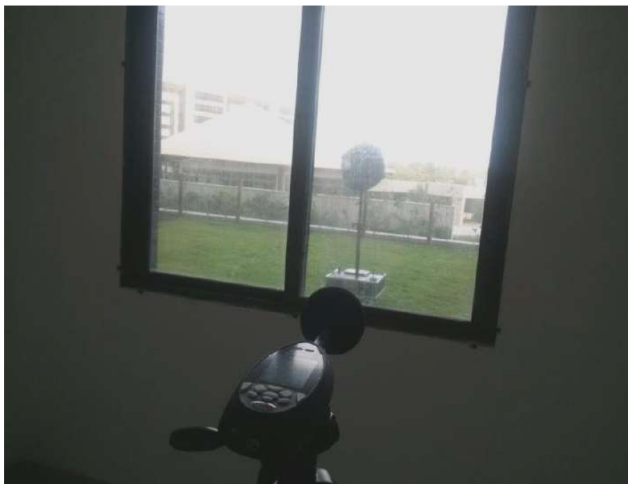
Figura 3 – Coleta dos ruídos de fundo e de recepção para o ensaio na vedação externa -
