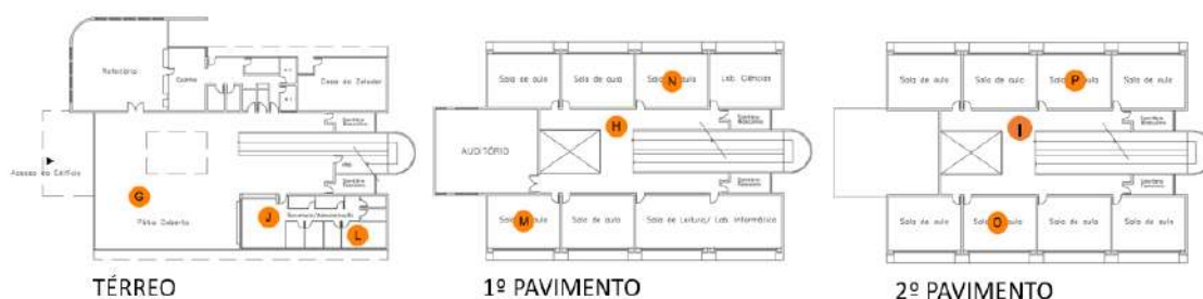
Figura 9 – Esquema com os Pontos de Medição por pavimento da Escola -
