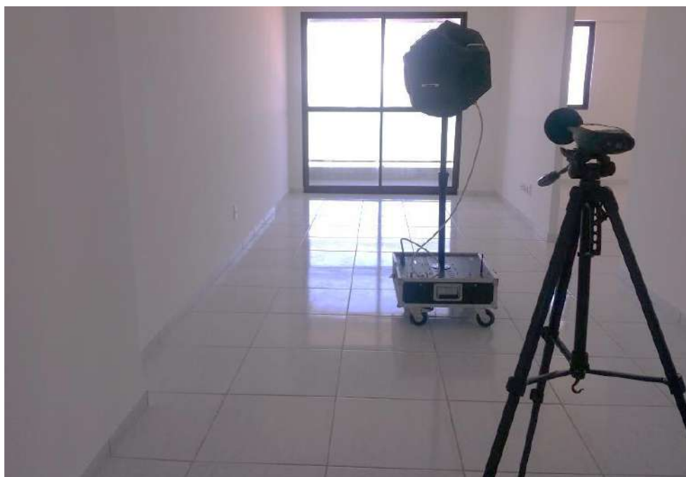
Figura 1- Medidor de nível de pressão sonora e fonte de ruído - Fonte: ANDRADE (2017)
