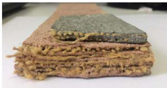
Figura 4 – Amostras do compósito formado por matriz cimentícia com fibras naturais vegetais.
