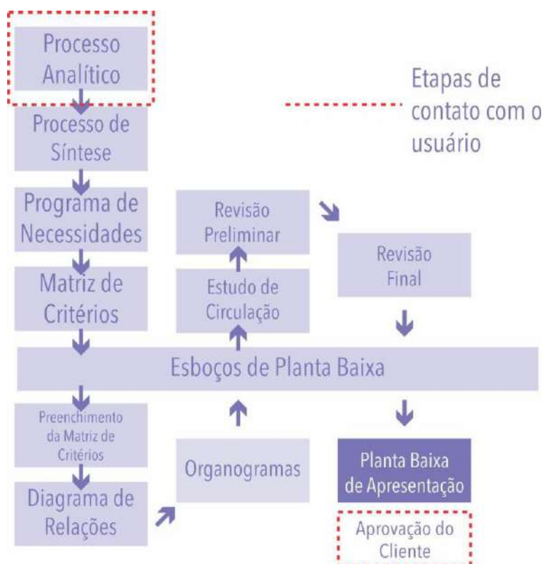
Figura 5 – Fases da Metodologia proposta por CHING E BINGGELI (2013) e sinalização daquelas em que há relação com o usuário/ou cliente
