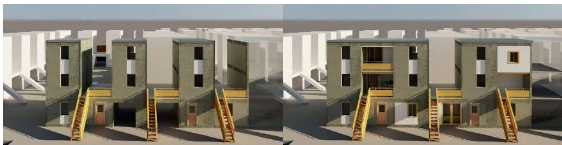
Figura 1 – Imagem do modelo Autodesk Revit 2018 do projeto Quinta Monroy do arquiteto Alejandro Aravena, antes e depois das alterações -
