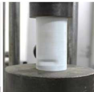
Figura 4 – Teste de compressão axial CP cilíndrico em ABS -
