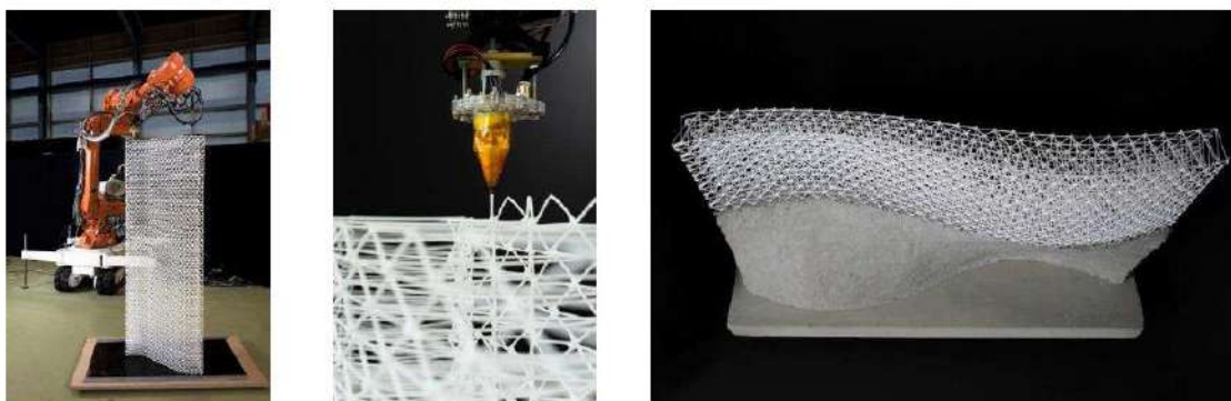
Figura 2 – (A) Impressão através do braço robótico, (B) Bico extrusor no ato da impressão e (C) Sistema Mesh Mould de impressão 3D -
