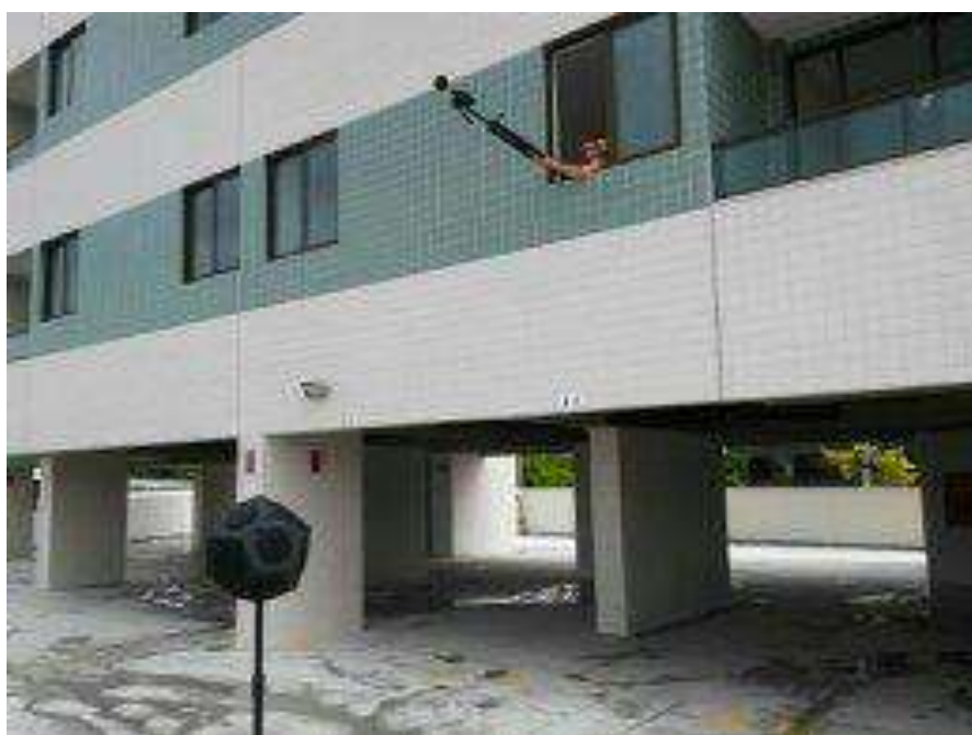
Figura 2 – Coleta do ruído de emissão no ensaio da vedação externo no 1º pavimento - Fonte: ANDRADE (2017)
