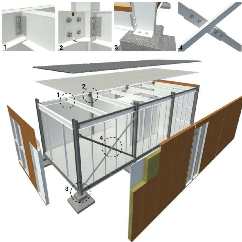
Figura 5 – Detalhes de Montagem -
