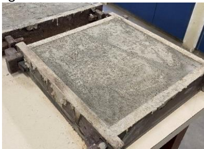
Figura 4 – Placas antes da desforma
