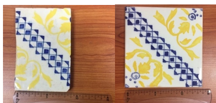
Figura 3 – Amostra azulejar antiga (à esquerda) e réplica (à direita).
