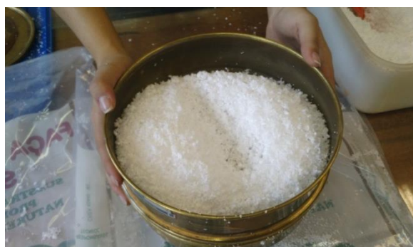
Figura 1 – Poliestireno expandido sendo peneirado
