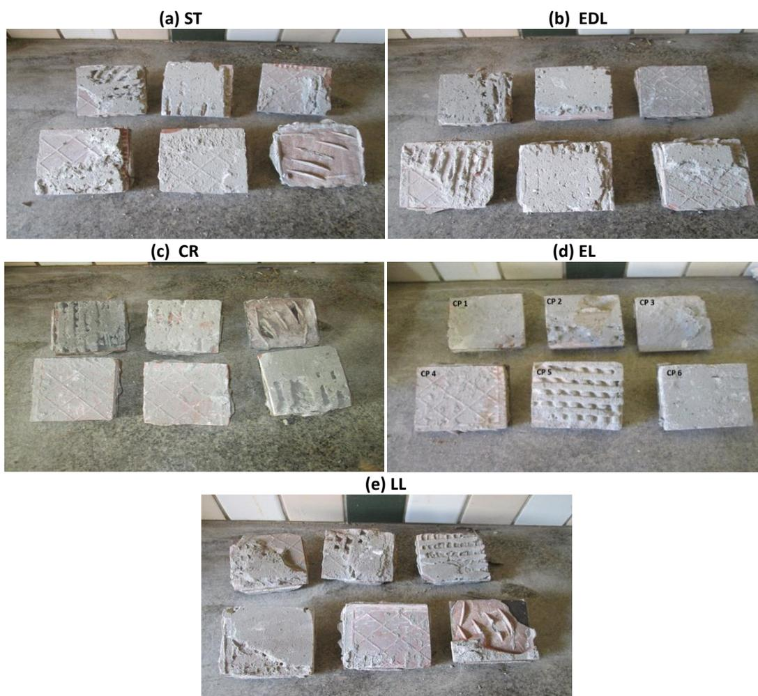
**Fonte:** Autor. Legenda: **(a)ST**: Sem tratamento superficial; **(b)EDL**: Escovado manualmente com detergente neutro e lavado com água pressurizada; **(c)CR**: Chapisco rolado; **(d)EL**: Escovado manualmente e lavado com água pressurizada; **(e)LL**: Lixamento mecânico e lavado com água pressurizada.
