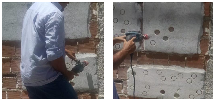
Figura 3 e 4. Preparação dos corpos de prova - cortes circulares
