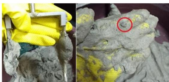
Como o propósito da reometria rotacional é simular as condições às quais as argamassas serão submetidas durante os processos de preparo, transporte e aplicação, o estudo da variação do torque com o tempo traz informações importantes sobre a eficiência do material. A argamassa B não apresentou comportamento adequado, indicando a instabilidade reológica como fator interveniente ao seu uso seguro e podendo gerar manifestações patológicas em sua aplicação.
