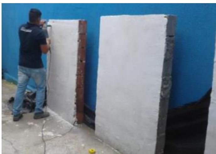
Figura 2 - Corte das pastas para realização dos ensaios de aderência
