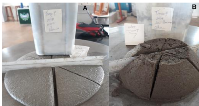
Figura 1 – Consistência da argamassa com traço 4: (a) com lâmina d' água; (b) sem lâmina d' água.
