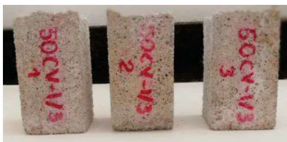
Figura 2 – Corpos de prova de cinzas volantes no 1º ciclo do ensaio de cloretos
