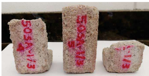
Figura 4 – Corpos de prova de sílica ativa no 10º ciclo do ensaio de sulfatos
