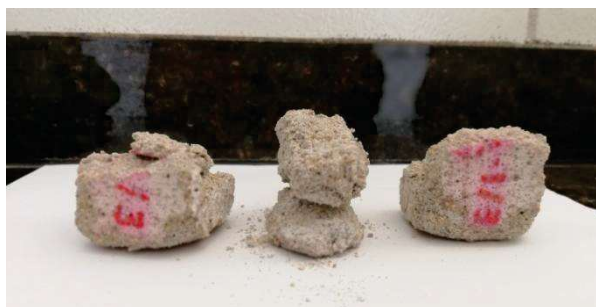
Figura 5 – Corpos de prova de sílica ativa no 13º ciclo do ensaio de sulfatos
