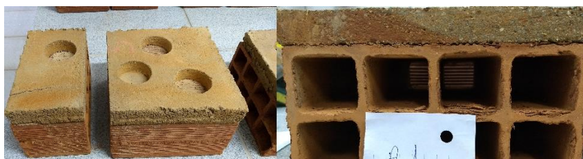
Figura 2 – Procedimento para análise de extensão de aderência
