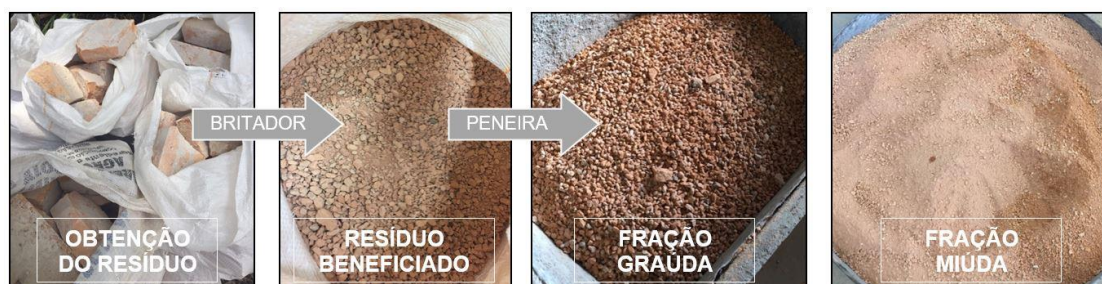
Figura 1 – Processo de beneficiamento do resíduo de cerâmica vermelha
