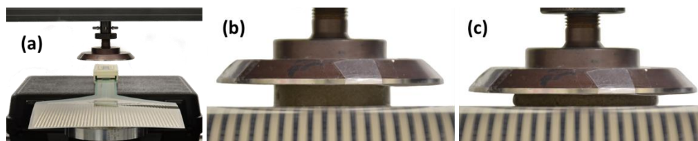
Figura 2 - (a) Sensor posicionado na máquina universal; (b) início; e (c) final de ensaio.
