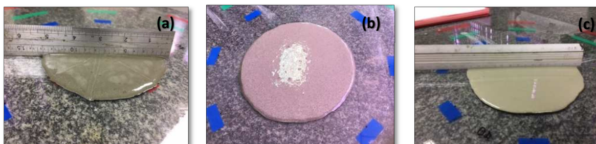
Figura 6 - Ensaio de espalhamento: argamassas T11 (50%) (a); T12 (40%) (b); TCOMERCIAL (c)
