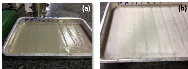
Figura 4 - Ensaio de “healing time”: argamassa no estado fresco (a) e no estado endurecido (b)
