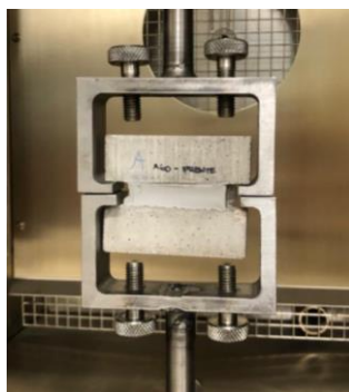
Figura 1 - Ensaio de adesão/coesão em temperaturas variáveis pela ABNT NBR ISO 9047:2021
