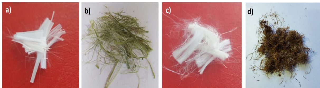
Figura 2 – Aparências das fibras empregadas: a) fibra de vidro, b) fibra de abacaxi, c) fibra de poliéster, d) fibra de aço
