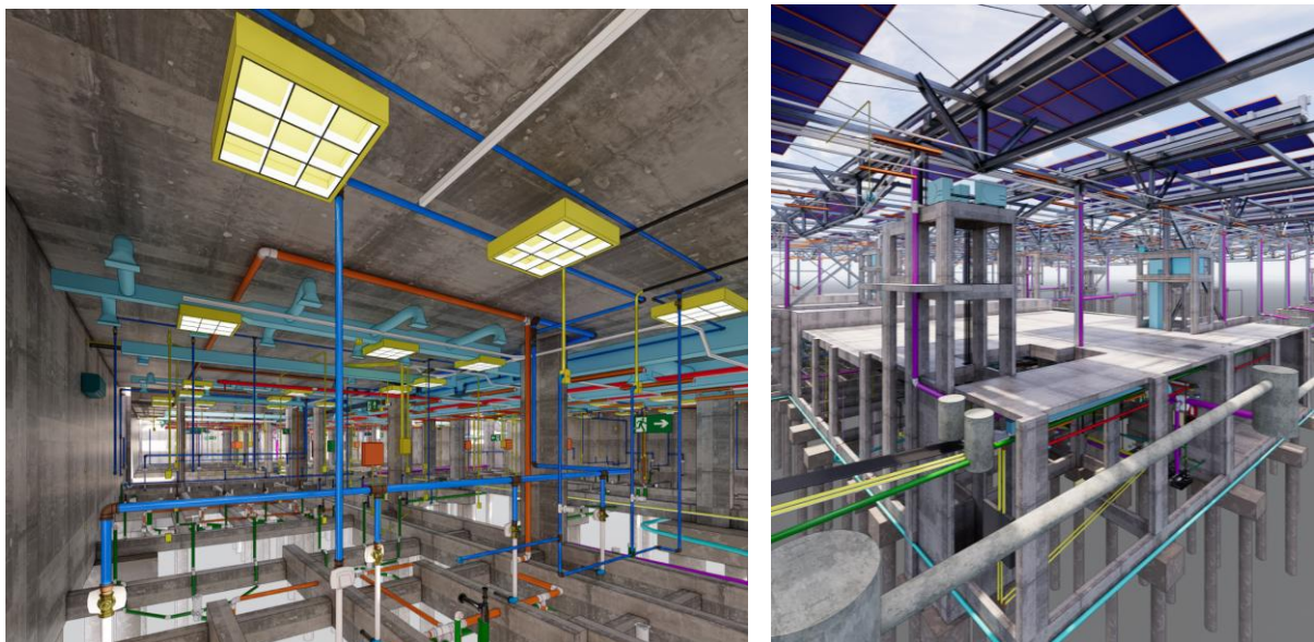
Figura 6: Vista da modelagem BIM federada das instalações prediais e estruturais do Terminal Capão da Imbuia
