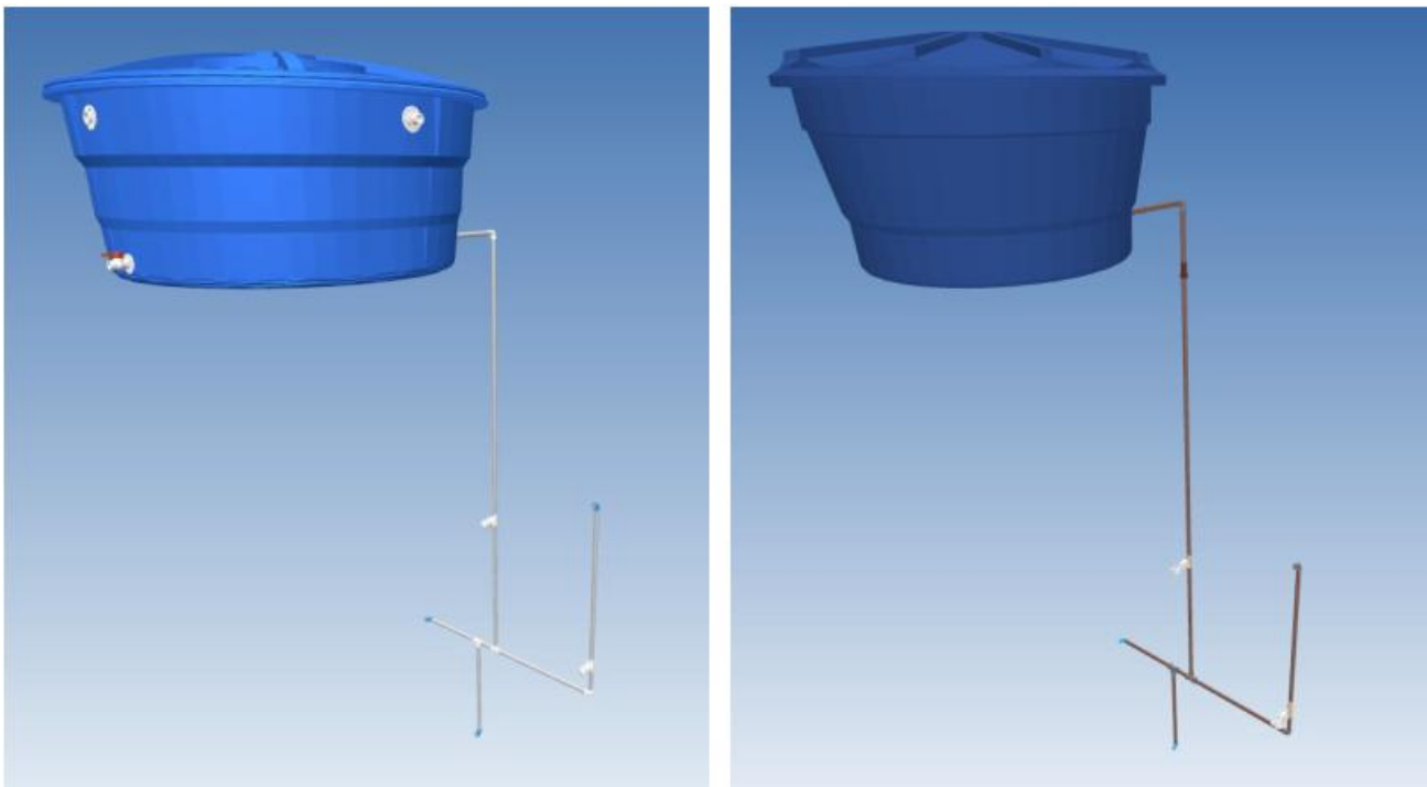
Figura 3: Sistema hidráulico modelado no Autodesk Revit 2024 e calculado com o script implementado (esquerda) e modelado e calculado utilizando o AltoQi Builder (direita).
