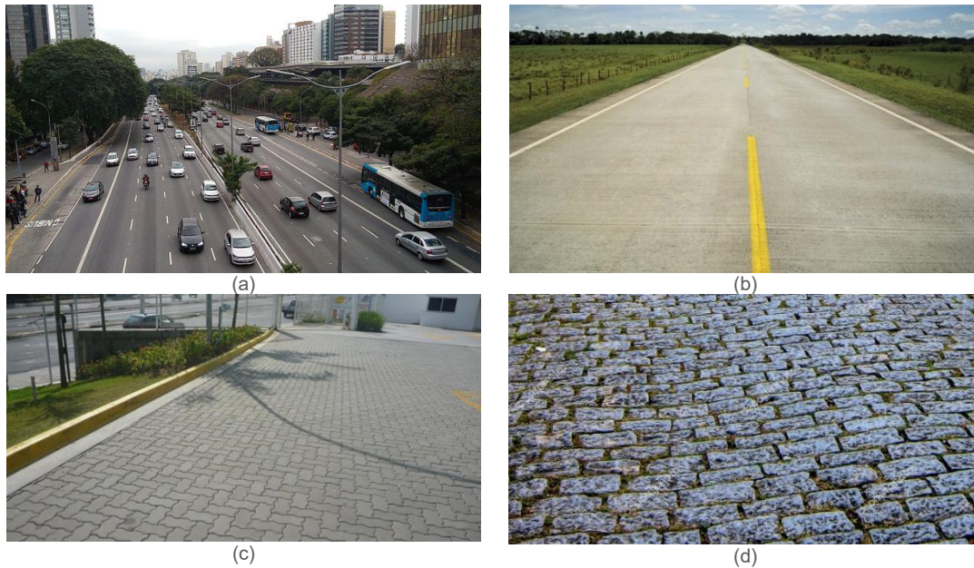
Figura 2: Classes de Interesse. (a) revestimento asfáltico, (b) concreto, (c) bloco intertravado, (d) paralelepípedo.
