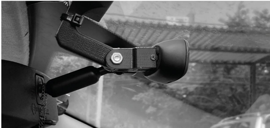
Figura 7: Posição de instalação da câmera.
