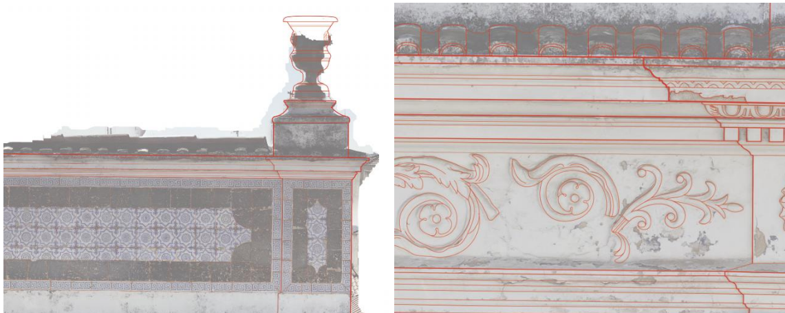
Figura 18: Sobreposição do desenho da elevação (em vermelho) sobre a ortofoto. Vaso da extremidade direita da platibanda, que foi recomposto por meio de outros recursos (à esquerda) e danos físicos aparentes representados no desenho (à direita).
