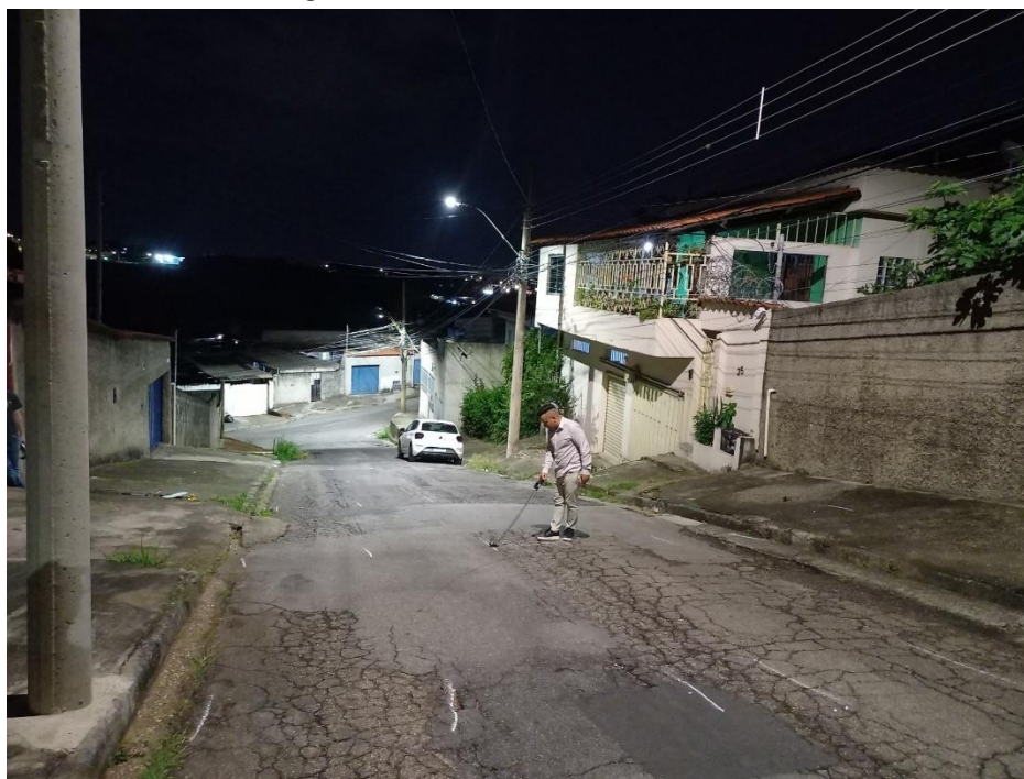
Figura 7 – Medições de iluminância in loco
