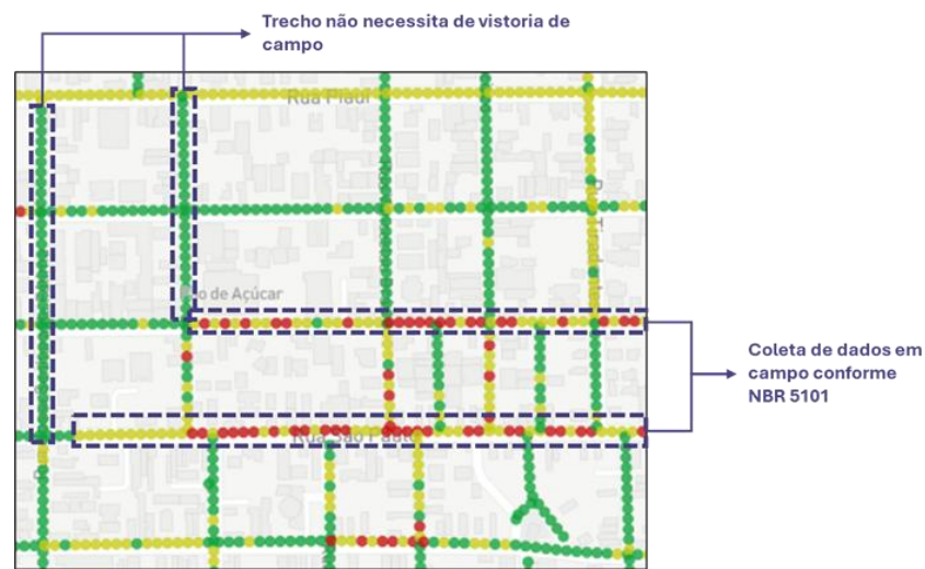
Figura 10: Resultados de medições com dispositivos IoT
