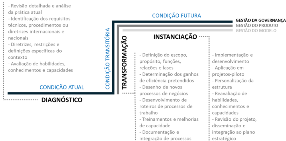
Figura 1: Diagrama-síntese dos frameworks para implementação BIM em empresas
