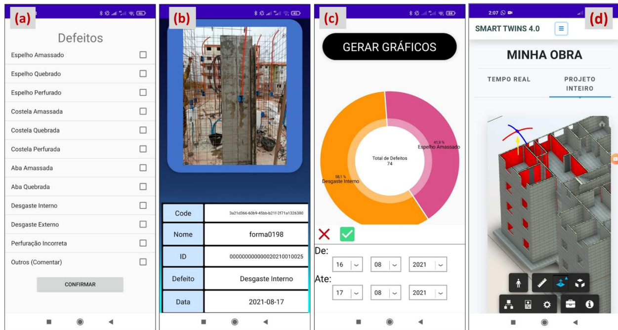
Figura 10: Telas do aplicativo: (a) defeitos listados para inspeção, (b) exemplo de registro de um defeito e (c) exemplo de gráfico gerado pelo aplicativo, (d) visualização dos resultados no ambiente BIM na Web.
