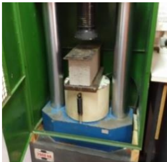
Figura 7 – Prensa EMIC DL 200 - Ensaio de Compressão Axial
