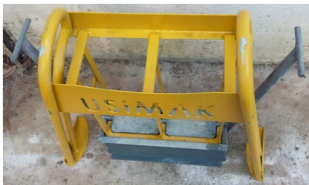
Figura 4 – Forma USIMAK para Produção Manual de Blocos de Concreto
