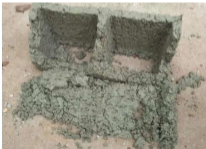
Figura 5 – Bloco de Concreto Desmanchado no Processo de Moldagem
