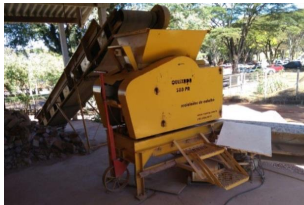
Figura 3 – Triturador de Mandíbula Queixada 300
