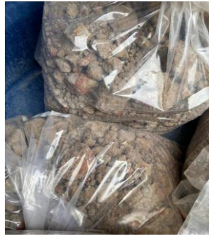
Figura 4 – Destorroamento de materiais. a) Partículas aglomeradas. b) Material desagregado.
