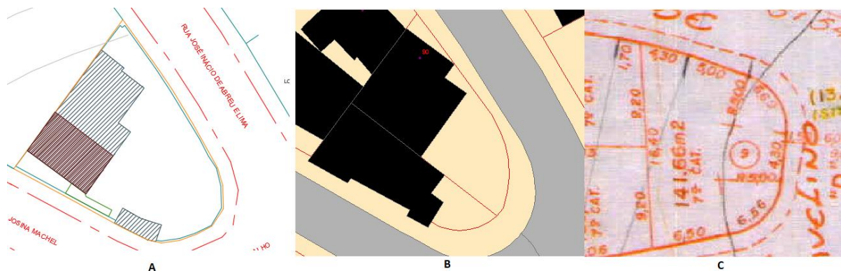
Figura 4 – Comparação entre cadastros físico (a), geográfico (b) e legal (c)
