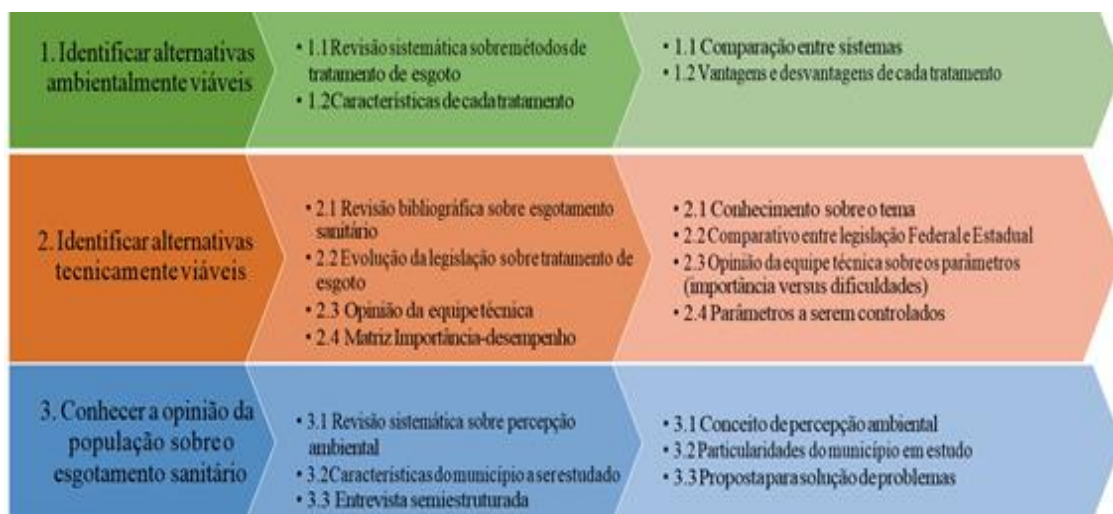
Figura 4 – Etapas de desenvolvimento de uma ferramenta de seleção de alternativas no tratamento de esgoto
