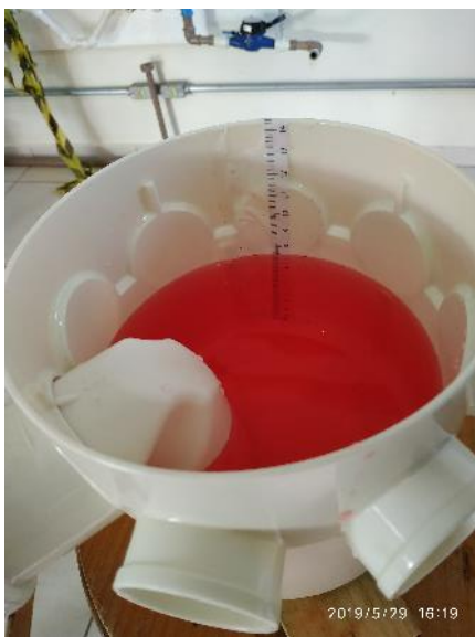
Figura 6 - Fita graduada fixada na caixa sifonada
