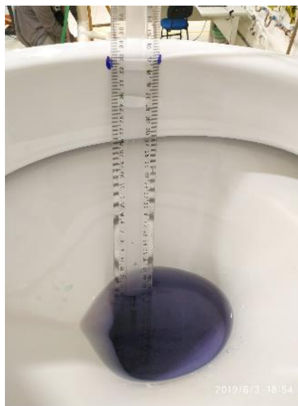
Figura 7 - Régua fixada na bacia sanitária
