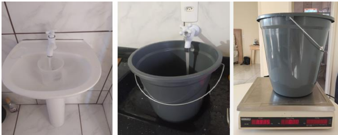
Figura 2 – Execução das medições das vazões
