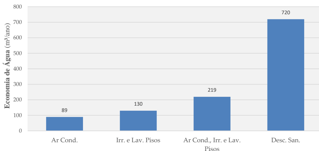
Figura 4 – Análise do potencial de redução do consumo de água pelo reúso de água cinza.
