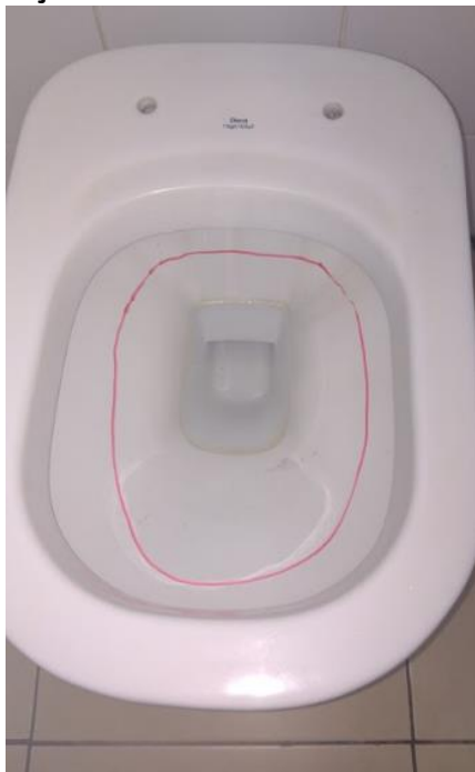
Figura 2- Aplicação do método da caneta na bacia sanitária.
