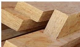
Figura 11 – Peças estruturais em LSL
