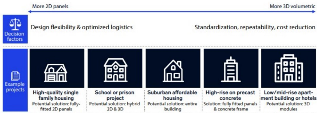
Figura 3 – Relação entre tipo de construção e o nível de modularização necessário.
