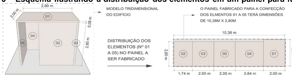
Figura 10 – Esquema ilustrando a distribuição dos elementos em um painel para fabricação
