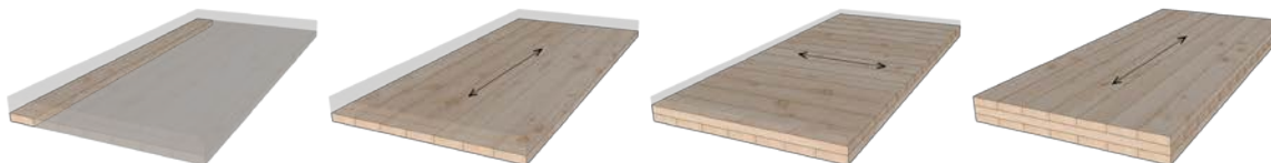
Figura 1 – Esquema de montagem de um painel de CLT
