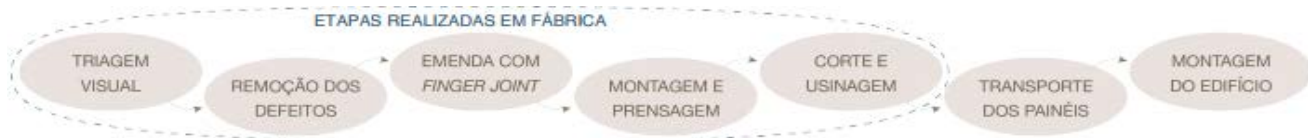
Figura 6 – Esquema ilustrando o processo construtivo de edifícios em CLT
