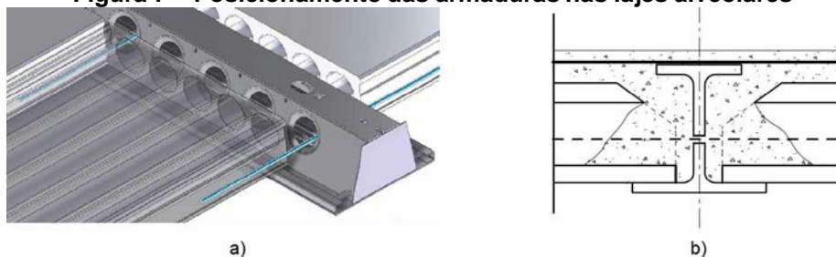
Figura 7 – Posicionamento das armaduras nas lajes alveolares
