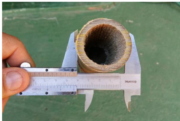
Figura 2 – Detalhe da seção do Bambusa tuldoídes
