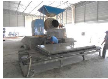
Fotografia 1 – Armaduras posicionadas e concretagem dos painéis (autores, 2015)
