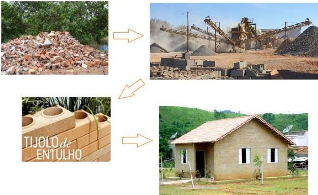
Figura 1 – Deposição irregular, Usina de reciclagem, Tijolo de entulho e Construção feita com tijolo de entulho.
