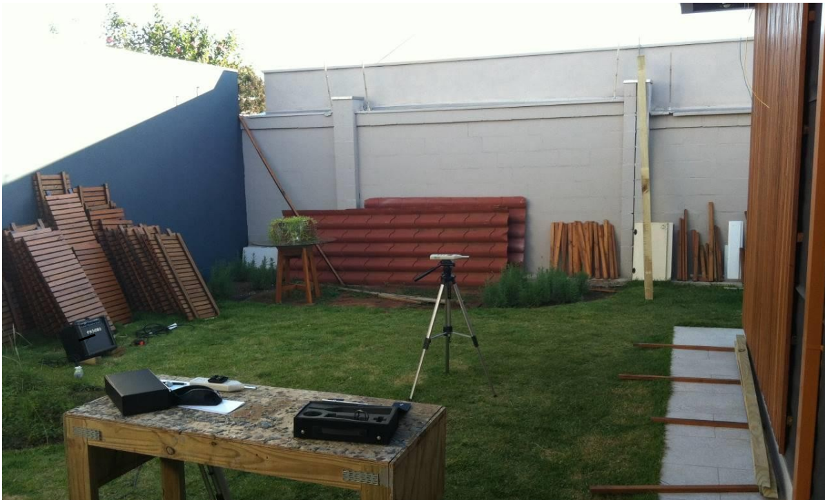
Figura 4 – Ensaio realizado em campo pelo método de engenharia para determinação do isolamento sonoro global da vedação externa (conjunto fachada e cobertura)
