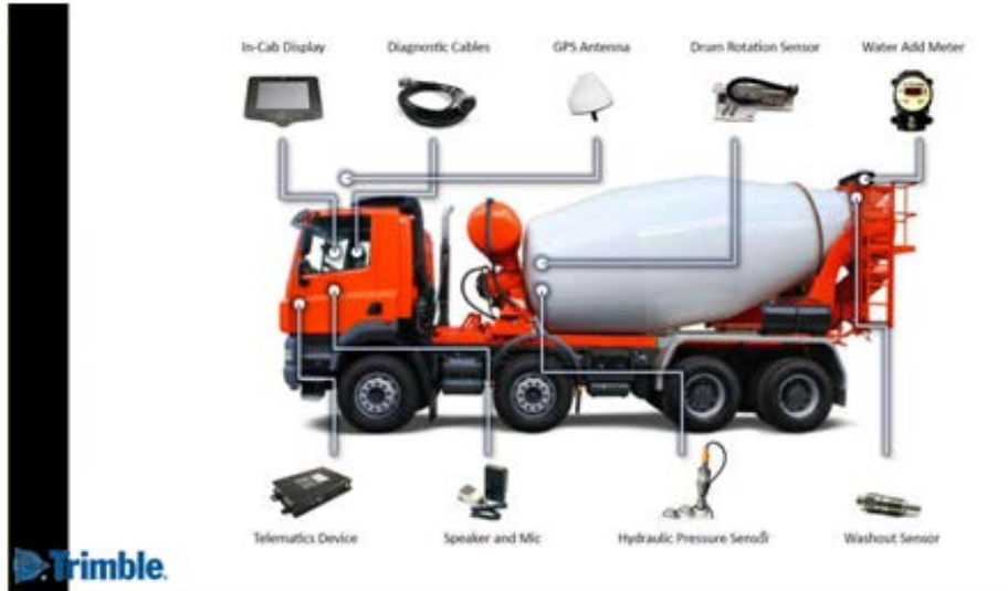
Figura 2. Sistema Globais de Navegação por Satélite (GNSS) propostos pela empresa Trimble para uso em caminhões betoneira.
