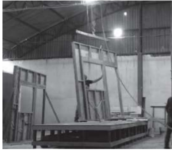
Figura 2 – Painel no sistema wood frame sendo movido em ambiente fabril
