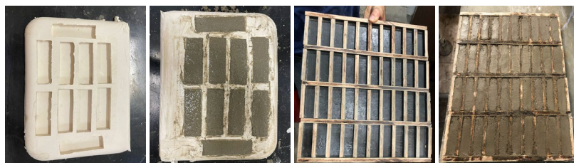
Figura 2: Protótipos de formas para moldagem dos substratos de argamassa. Forma moldada em silicone Teste A (primeira, à esquerda); forma com mistura de argamassa Teste A (segunda, ao centro); Forma de madeira compensada do Teste B (terceira, ao centro); forma com mistura de argamassa Teste B (quarta, à direita).
