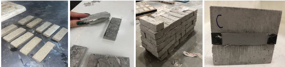
Figura 4: Substrato Argamassa e corpos de prova com selante. Substratos Teste A (primeira, à esquerda); Perda de adesão Substrato Teste A (segunda, ao centro); Substratos do Teste B (terceira, ao centro); Corpo de prova sem perda de adesão Teste B (quarta, à direita).
