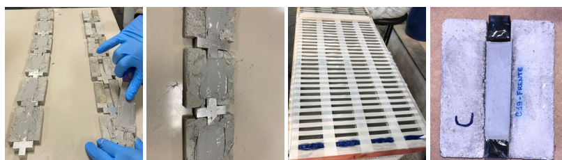
Figura 3: Montagem dos corpos de prova com selante. Aplicação selante Teste A (primeira, à esquerda); corpo de prova moldado Teste A (segunda, ao centro); Aplicação do selante do Teste B (terceira, ao centro); corpo de prova moldado Teste B (quarta, à direita).
