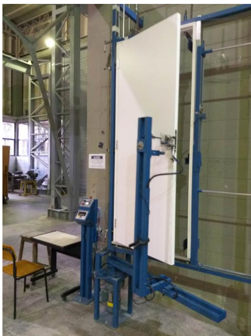
Figura 1 - Equipamento para realização de ensaios de ciclos de abertura e fechamento instalado no LCSC, IPT
