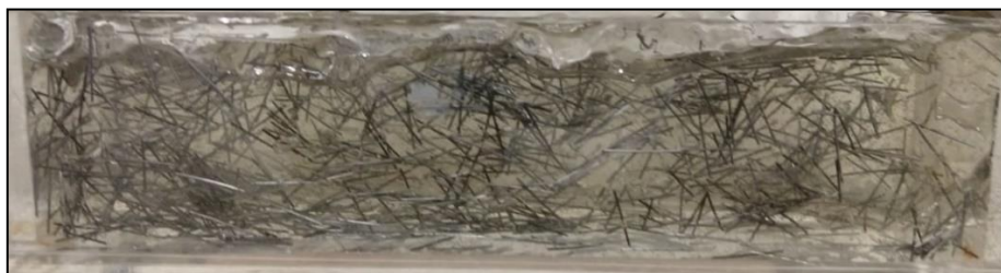
Figura 2 – Fibras (a) desalinhadas (0 A) e (b) alinhadas (12 A) devido ao campo magnético.
